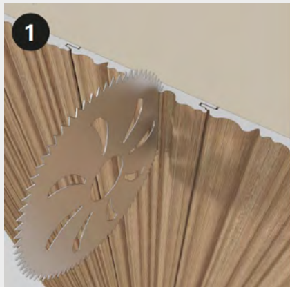
1 Il pannello danneggiato deve essere tagliato in due punti come mostrato in figura.
